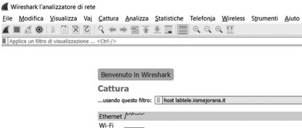
Figura 2 Applicazione di un filtro di cattura nella schermata iniziale di Wireshark
