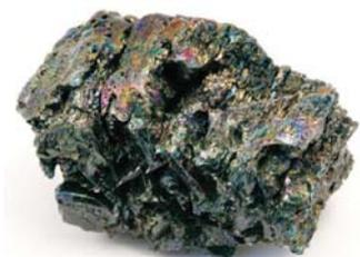
Il silicio è un semimetallo largamente usato nell'industria elettronica. Esso si comporta come un *semiconduttore*, ovvero conduce l'elettricità ad alta temperatura mentre si comporta come un isolante a bassa temperatura.
