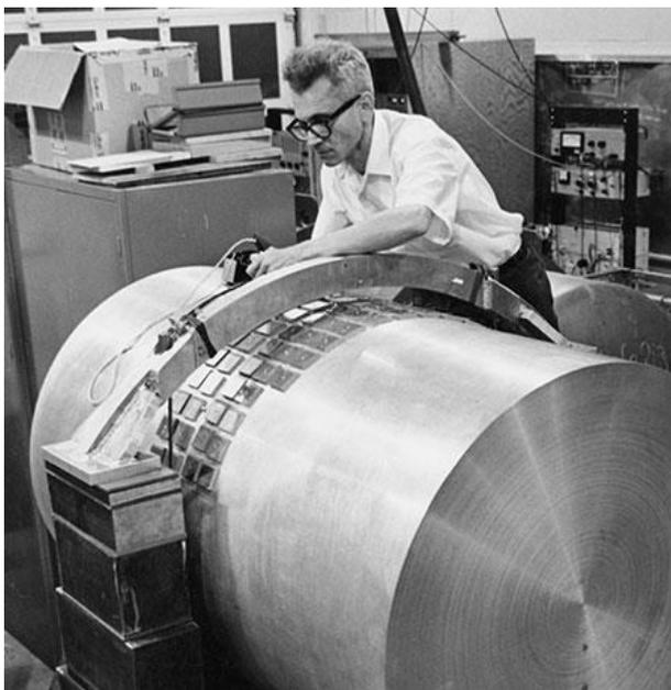
L'onda gravitazionale è come un martello che colpisce la barra e la fa vibrare. Bisogna dunque misurare la vibrazione di questo cilindro.
